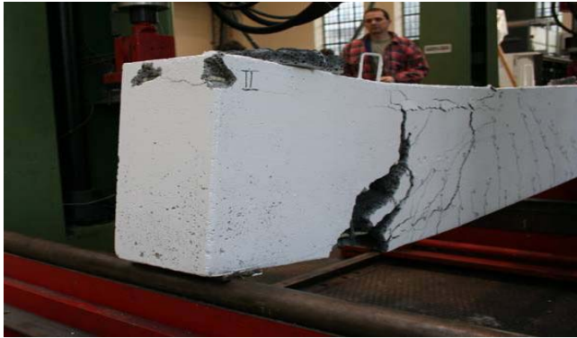
Bild 7. Balkenversuch aus Infraleichtbeton Fig. 7. infra-lightweight concrete beam with pushed-out upper reinforcement layer
