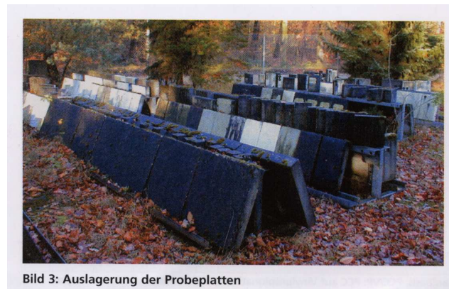
Bild 3: Auslagerung der Probeplatten
